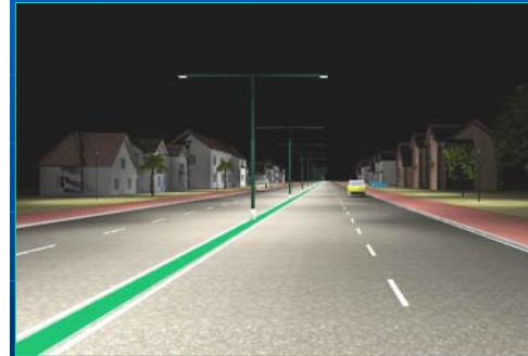
Geometría : Central con doble fila de luminarias e inclinación de pescante = 0^\circ
